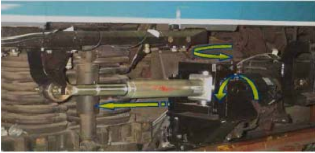
Fig. 10 Active yaw damper of Politecnico di Milano
