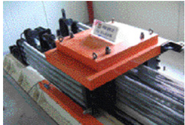
그림 6. 4층 바닥에 설치된 HMD 가진기
