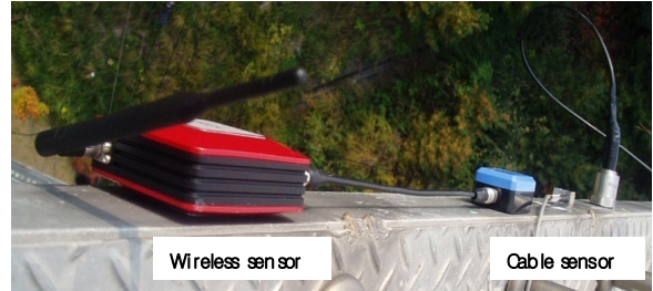
그림 7. 유무선 가속도 센서
