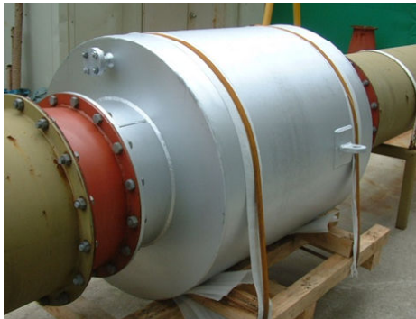
Figure 4 공명형 소음기 설치 모습
