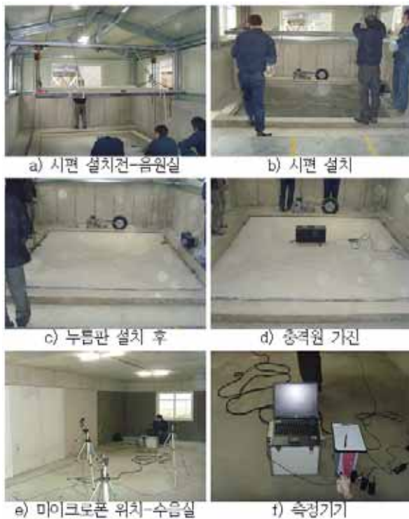
그림 1. 실험동에 시편설치 및 실험장면
