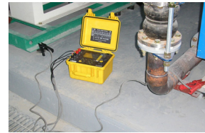
<그림 7> 기기 외함간의 연속성 측정(펌프 외함간)
