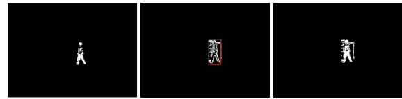
<그림 2> 바운딩 박스 안쪽의 실루엣에 대한 전경 영역이 차지하는 비율 : (a)전경 영상 (b) Spatial gradient의 실루엣 영상 (c)실루엣에 대한 모폴로지(팽창)방법+ HSI 칼라 모델을 이용하여 제거된 전경 영역을 복구하는 영상
