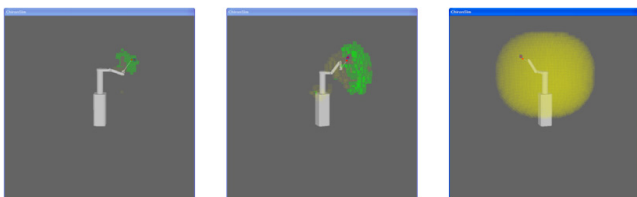
〈그림 5〉 가상의 목표점으로 로봇팔이 이동하여 로봇이 움직일 수 있는 공간을 시각적으로 표현한다.
