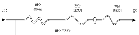
<그림 5> 급수분사에 의한 과열기 온도제어
