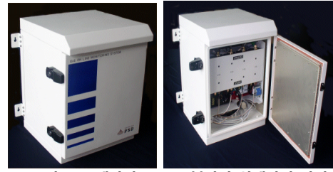
〈 그림 9 〉 개발된 GIS 부분방전 상태감시 장치
