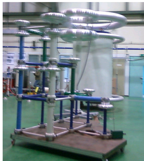
〈사진 1〉 Dielectric Tester (Haefly)는 AC/DC 400kV고압발생장치
