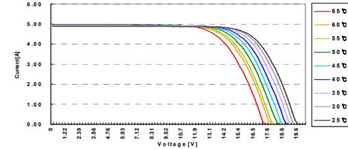
〈그림 9〉 모듈의 온도변화에 따른 I-V Curve 변화
