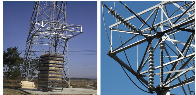
(a) 산불 모의시험장 (b) 애자 시료 설치
