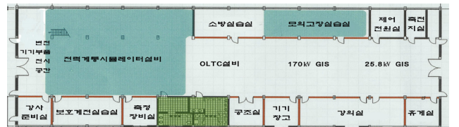
〈그림 1〉 옥내변전실습장 평면도
