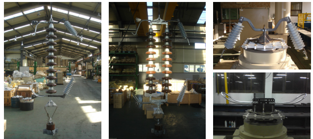
(1) 1련 현수장치 (2) 2련 현수장치 (3) 진동피로시험
