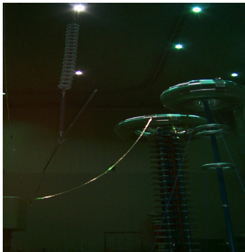
〈그림 7〉 내충격 내전압 및 섬락전압시험
