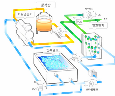
<그림 2> 축냉식 냉방시스템의 구조(주간동시운전)[3]
