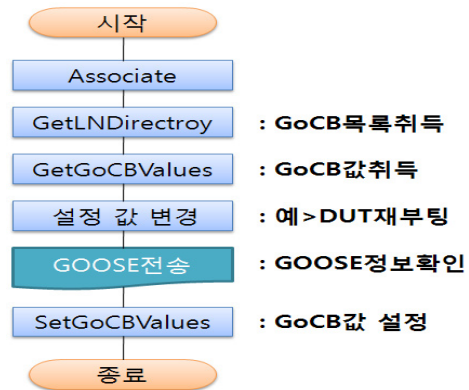
<그림 2> GOOSE 송신시험 수행 흐름도
