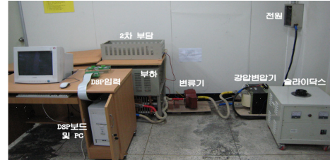
그림 6 실제 변류기 실험 모델 계통
