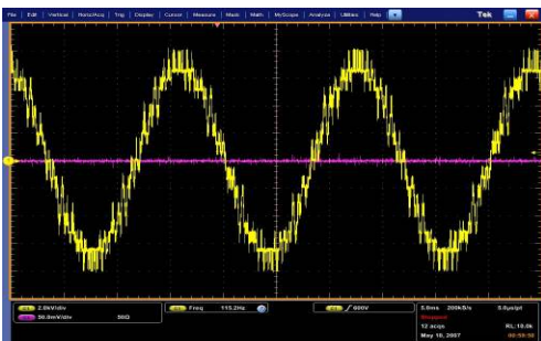
그림 5 HBML 고압인버터의 출력전압 파형(2kV/div) Fig. 5 Output Voltage Waveform of HBML Medium Voltage Inverter(2kV/div)
