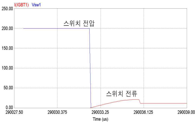
그림 6 제안된 컨버터의 소프트 스위칭 <Turn-On> Fig. 6 Soft switching of the proposed converter <Turn-On>
