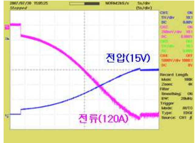
그림 8. 필라멘트 전원장치 실험 파형
