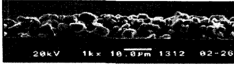
그림 4. 최적화된 형광막의 SEM 사진 (단면) Fig. 4. SEM image of anode phosphor layer by screen printing method (section-view)
