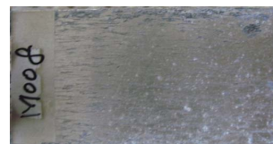
그림 3. 산소 글로 방전으로 표면처리 된 마그네슘 판재의 염수 분무 시험 3시간 경과 사진.
