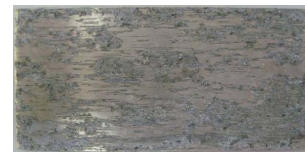
그림 1. 아세톤과 알코올 초음파 세척 후 마그네슘 판재의 염수 분무 시험 2시간 경과 사진
