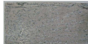
그림 2. 진공 용기 내에서 아르곤 글로 방전에 의해 청정된 마그네슘 판재의 염수 분무 시험 2시간 경과 사진.
