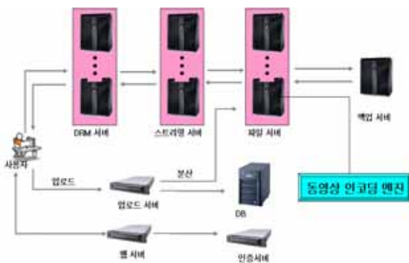
▶▶ 그림 1. UCC 동영상 서비스를 위한 시스템 구성도
