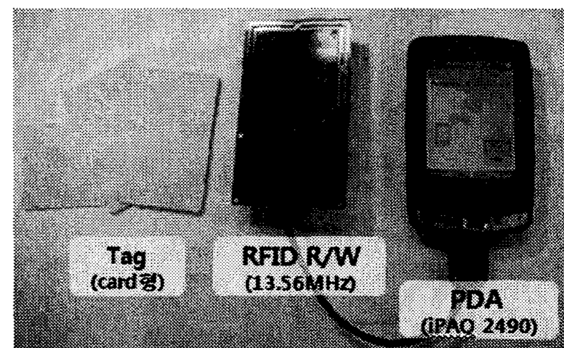
그림 3. PDA 기반의 RFID 리더/라이터 시스템의 구조
