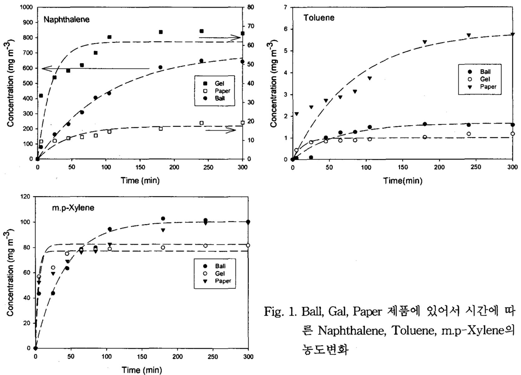
Fig. 1. Ball, Gal, Paper 제품에 있어서 시간에 따른 Naphthalene, Toluene, m.p-Xylene의 농도변화
