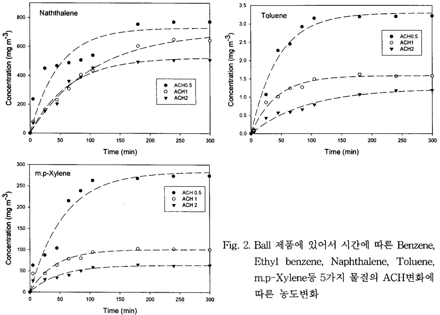
Fig. 2. Ball 제품에 있어서 시간에 따른 Benzene, Ethyl benzene, Naphthalene, Toluene, m.p-Xylene 등 5가지 물질의 ACH 변화에 따른 농도 변화
