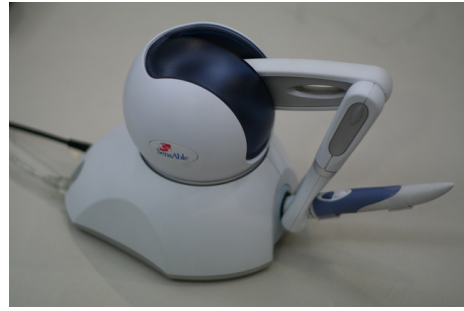
그림 3. 햅틱 그리드 생성 및 3차원 입력을 위한 PHANTOM® Omni™
