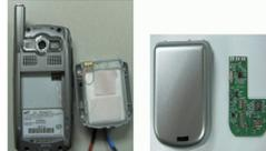
그림 7. 가속도/각속도 센서와 진동 구동부를 장착한 프로토타입 시스템
