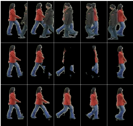
그림 10. 실험2: 움직이는 두 물체가 교차하는 영상, 위로부터 목표 프레임 영상, 가려진 물체 영상, 복원된 영상
