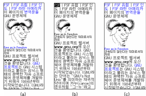
그림 10. GNU 사이트 변환 (a) 에뮬레이터에 변환 없이 출력, (b) crunch 상에서 변환 뒤 에뮬레이터로 출력, (c) 개선된 프록시에서 변환한 뒤 에뮬레이터로 출력
