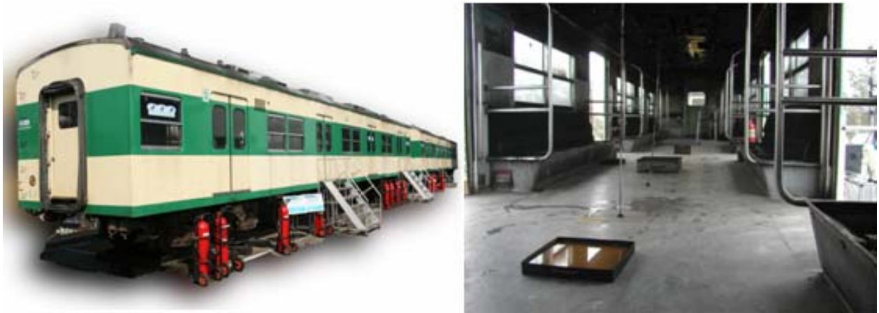
그림 4. 미세 물분무를 이용한 화재 성능시험 하기위한 객차(외·내부모습)
