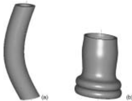
그림 3. Representative buckling modes. (a) global buckling, (b) local buckling.
