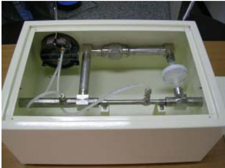
그림 3. 본 실험에 사용된 dilution tunnel
