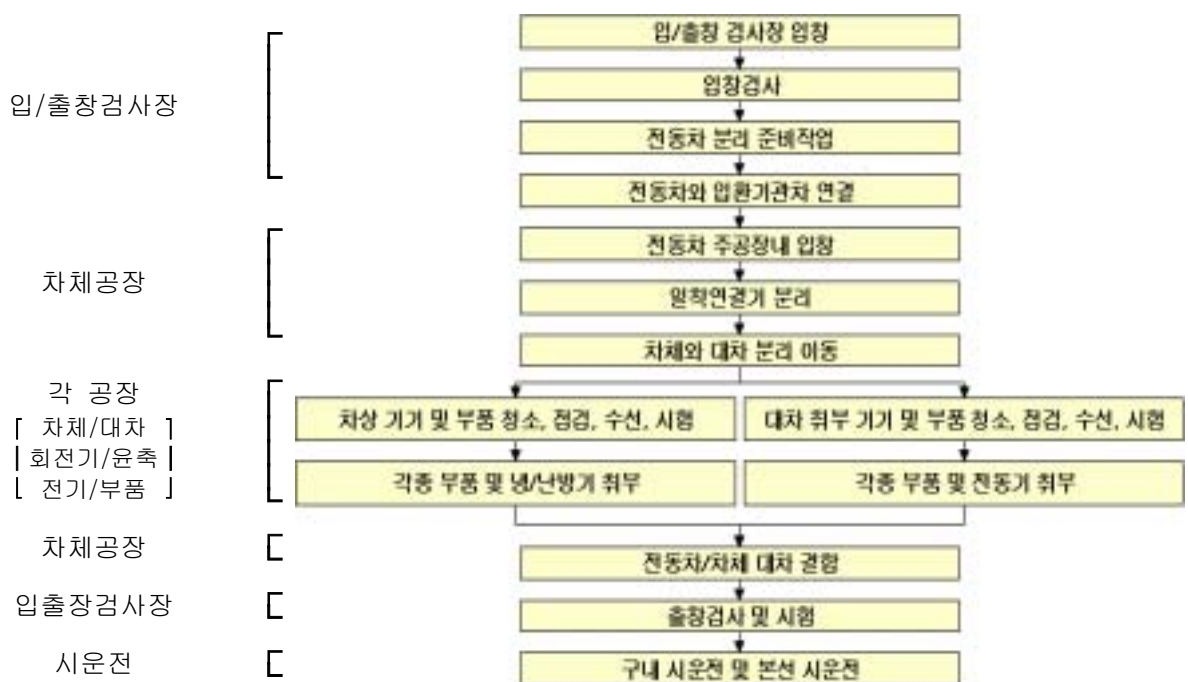
그림 3-1. 전동차 유지보수 주요공정 흐름도
