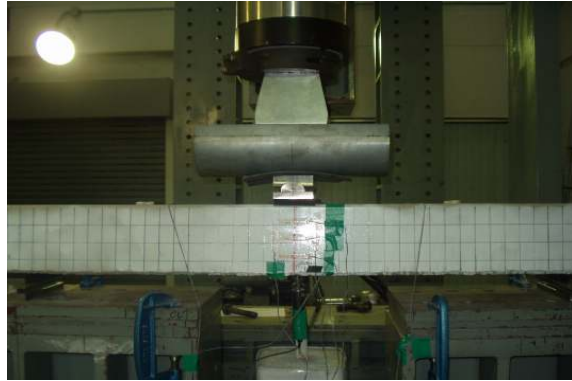
그림 8. Fbr ~ 피로시험: 재하 마지막단계
