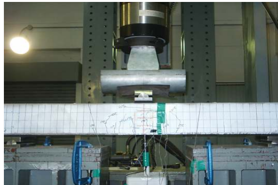
그림 10. 피로시험~FbB: 재하 마지막단계
