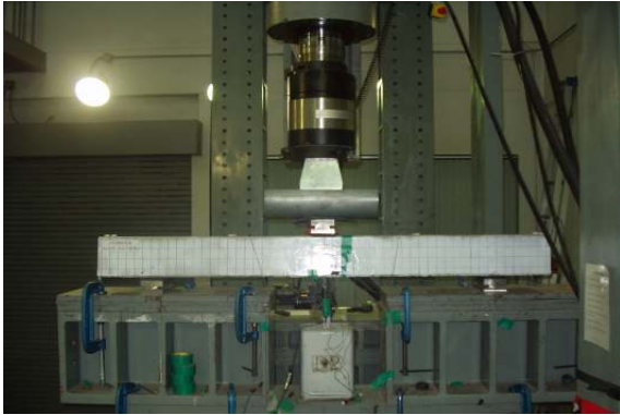
그림7. Fbr ~ 피로시험: 재하 초기단계
