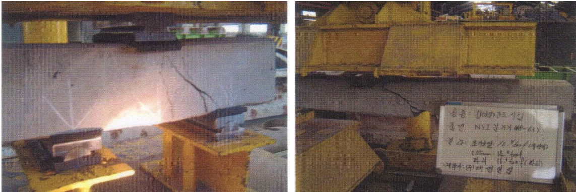
그림 5. PC침목 휨(균열)하중 시험 (레일 직하부, 중앙부)
