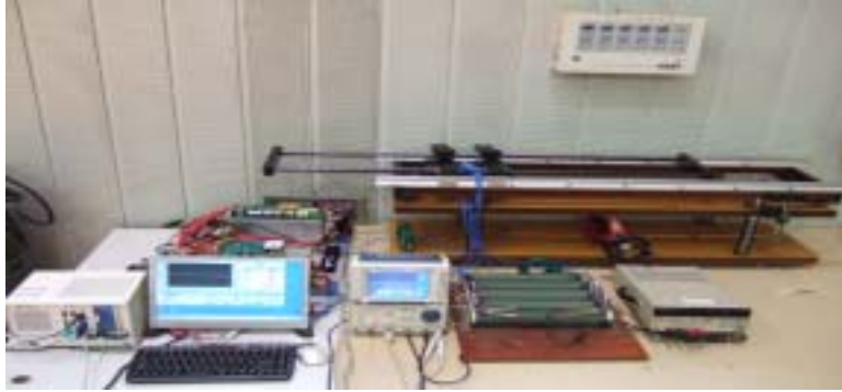
<그림 5> 유도 급전 시스템 실험장치
