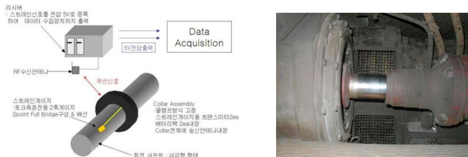
그림 5 윤축을 이용한 측정 방법
