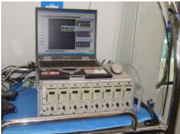
그림 4. 텔레미터 수신기와 하중신호 모니터링
