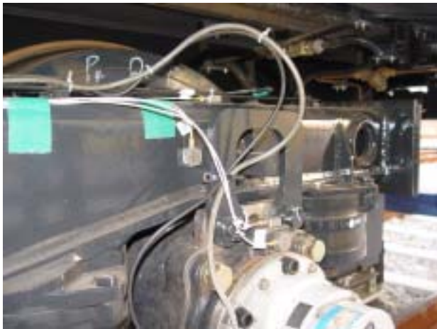
그림 2. 축상과 대차의 진동가속도 센서
