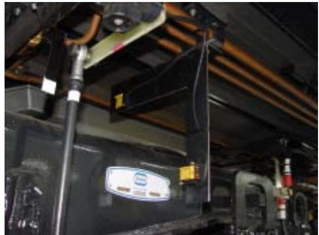
그림 3. 차체와 대차의 상대변위 측정센서
