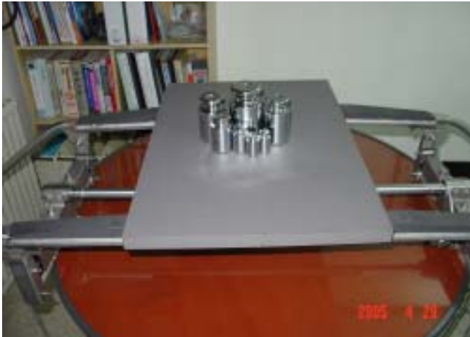
그림 8 분동 추를 이용한 하중인가 상태
