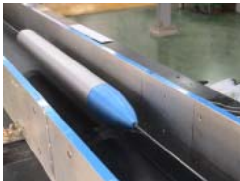
그림 4. KTX 모형 열차 및 방음벽
