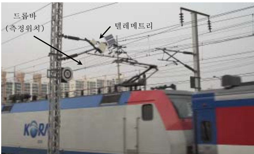
그림 1 충북선 전차선로 동특성 측정장면
