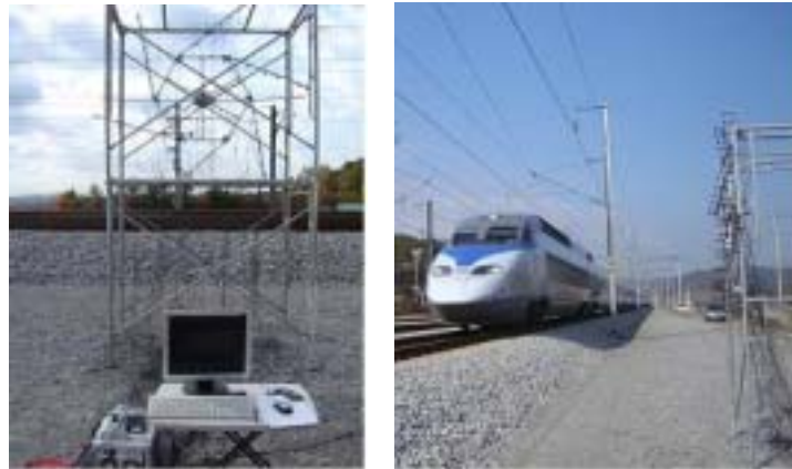
그림 6. 마이크로폰어레이를 이용한 고속열차 주행소음 시험 장면
