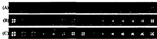
그림 2. 1Hz에서 전압을 증가시키면서 관찰한 수직 배향 액정 셀에서의 four-lobe texture patterns 현미경 사진 (a) 60 V (b) 100 V (c) 200 V
