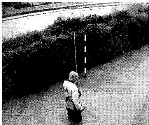
그림 3 수위표 설치 및 유속측정현황
