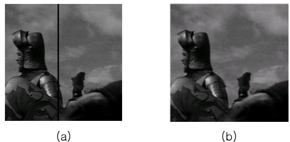
그림 7. 양선형 보간법 결과의 예 : (a) 스크래치와 원래 영상을 맵핑한 영상 (b) 양선형 보간법 결과 영상
