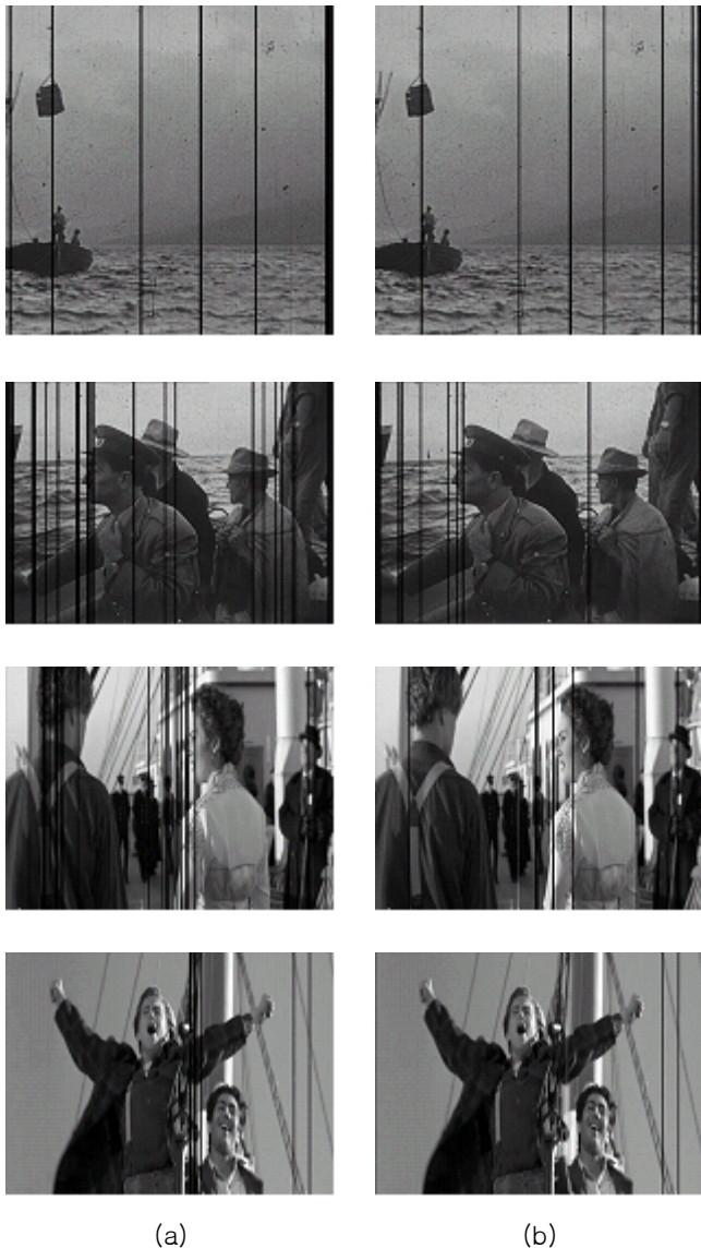
그림 11. 스크래치 검출의 예 : (a) Kokaram의 제안한 방법을 통한 검출결과, (b) 본 논문에서 제안한 방법을 통한 검출결과
