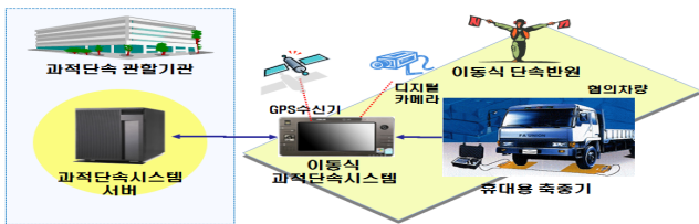
(그림 1) 이동식검문소용 과적단속시스템 구성도
