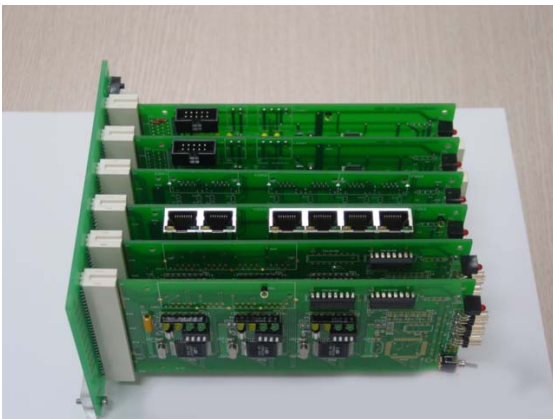
그림 4. 구현된 버스 중재기의 모습
