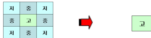
(그림 2) 각 이미지 블록의 FFT(Fast Fourier Transform) 적용하여 고주파 영역을 뽑아내는 과정
