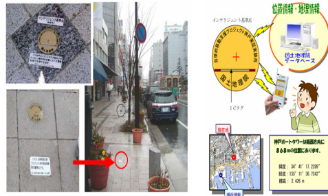
[그림 2] 일본 고베시에 설치된 인텔리전트기준점
