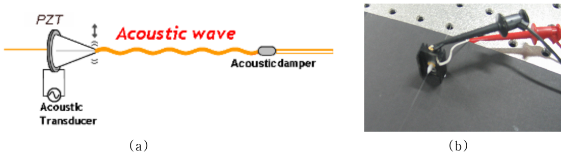
그림 1. (a) 음파 발생기의 구조 (b) 제작된 음파 발생기의 사진
